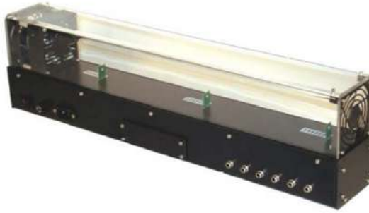
Figura 2: Experimento de flujo de calor. Fuente: (Quanser innovative Edutech, 2012)
