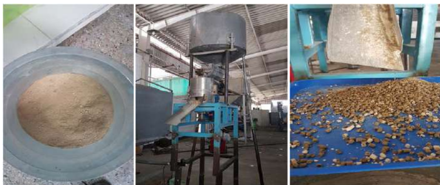
Figura 5. Proceso de pelletización y producto final, de los lodos de la vinaza.
